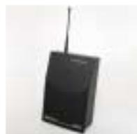
Questo utilissimo accessorio permette, da un qualsiasi telefono interno del sistema **XF400 (plus)**, di utilizzare un collegamento GSM per le comunicazioni indirizzate ai telefoni cellulari, mettendo a disposizione una ulteriore linea telefonica verso l'esterno e consentendo di ottimizzare i costi per questo tipo di chiamate. Esso permette, inoltre, la selezione diretta dell'interno desiderato per le chiamate entranti su tale collegamento GSM.
