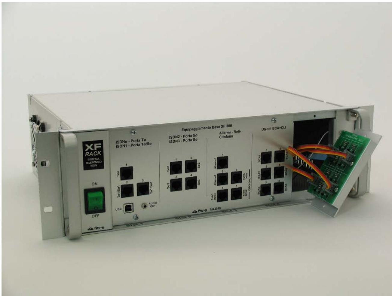
Il pannello frontale del rack è modulare e deve essere equipaggiato con le piastre frontali corrispondenti alle schede di ampliamento utilizzate. Ad ogni tipo di scheda di equipaggiamento delle centrali corrisponde una specifica piastra frontale con le relative prese ad innesto rapido.
