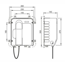
dimensions (W x H x D) 230,0 x 270,0 x 140,0 mm weight 5,9 kg
