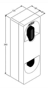
dimensions mm (W x H x D) 120,0 x 360,0 x 100,0 weight 3,3 kg
