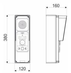
dimensions (W x H x D) 120,0 x 380,0 x 170,0 mm weight 2,4 kg
