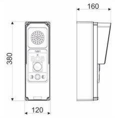
dimensions (W x H x D) 120,0 x 380,0 x 160,0 mm weight 2,4 kg
