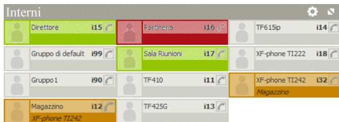
Grazie a **TK-Client**, il PC e il sistema **XF** lavorano insieme in modo efficiente ed integrato. Lo stato di libero o occupato degli interni sono visualizzate sui monitor dei PC della rete Aziendale ed ogni chiamata entrante viene segnalata direttamente sul PC, fornendo indicazioni sul chiamante e sulle note registrate su di lui in precedenza. Questo ancor prima di rispondere. E' inoltre possibile arricchire queste note durante o dopo la conversazione.
