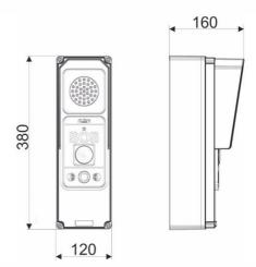
dimensions (W x H x D) 120,0 x 380,0 x 160,0 mm weight 1,5 kg
