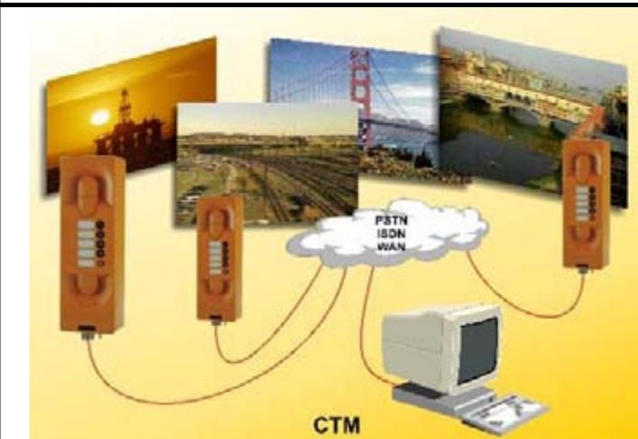
Postazione remota di Tele-Manutenzione Fitre **CTM** per la teleprogrammazione e la telediagnostica dei telefoni Fitre Tasvox serie 900 (ed altre), con accesso protetto da Password.
