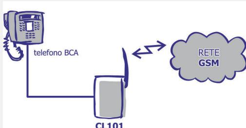
Un telefono analogico fisso (BCA) può essere usato per effettuare e ricevere conversazioni con i telefoni cellulari, stabilendo una comunicazione totalmente all'interno della rete GSM.
